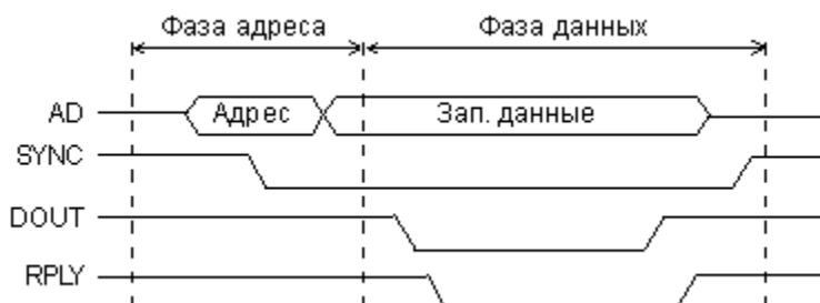
Рис. 5.2. Цикл записи на магистрали Q-bus.
