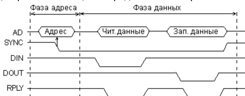
Рис. 5.3. Цикл «ввод-пауза-вывод» на магистрали Q-bus.
