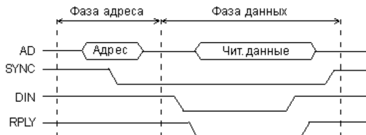
Рис. 5.1. Цикл чтения на магистрали Q-bus.
