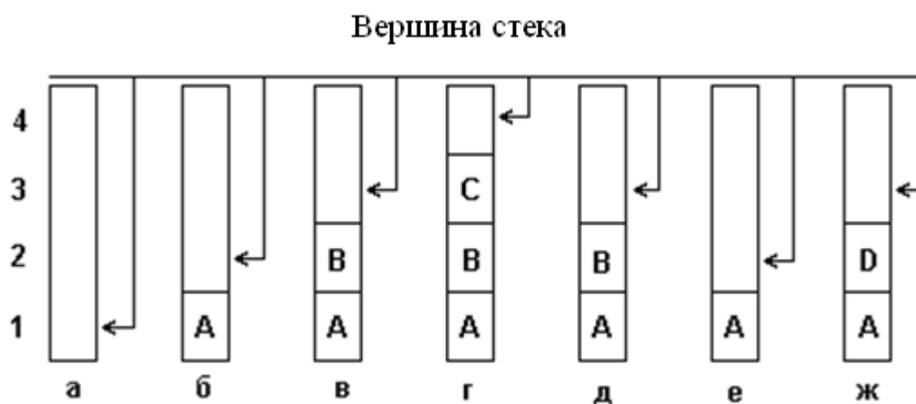
Рис. 14.1. Включение и исключение элементов из стека
