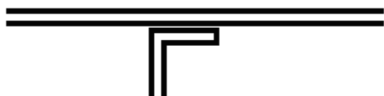
Рисунок 1.3 – Соединение внахлест под прямым углом
