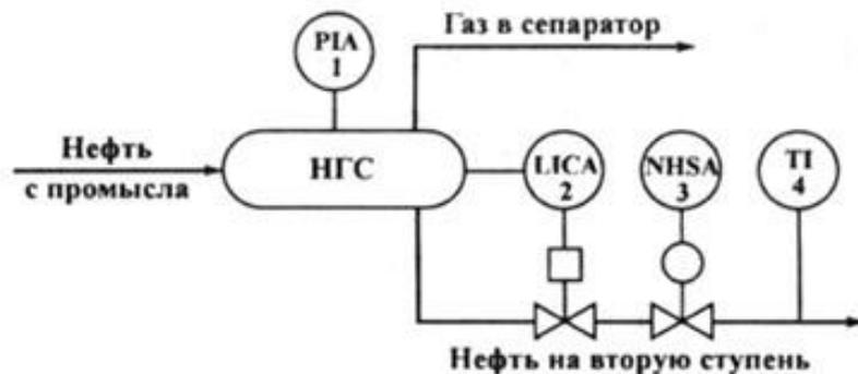
А) Давление в сепараторе – измерение, сигнализация;
