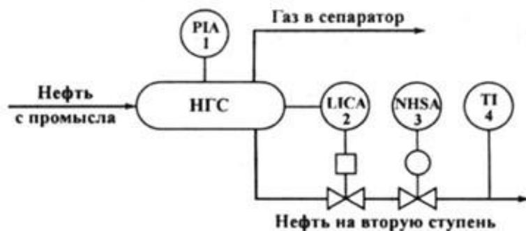
А) Давление в сепараторе – измерение, сигнализация;
