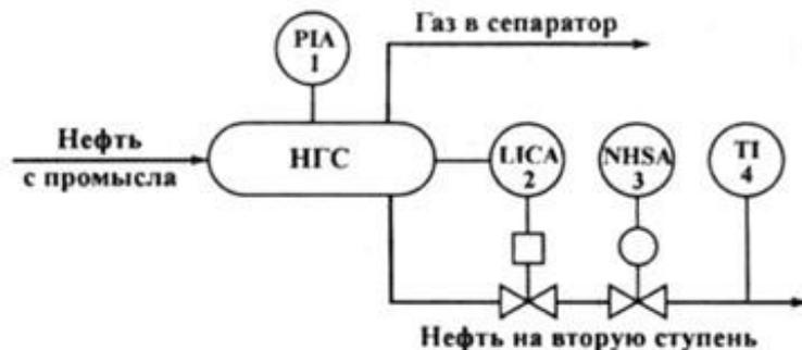
А) Давление в сепараторе – измерение, сигнализация;
