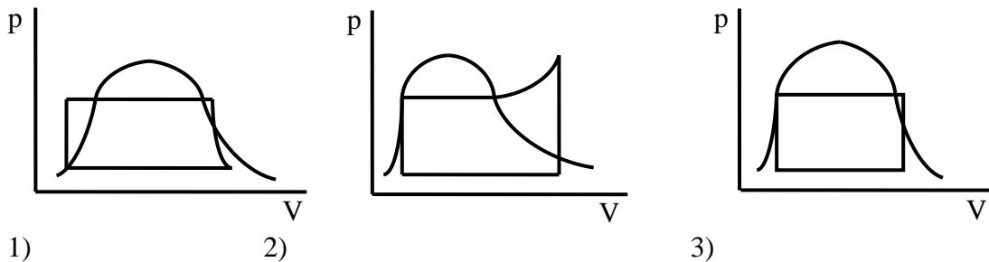
15. При анализе теплового баланса проектируемой системы цикл Тринклера в координатных осях P – V показан на диаграмме:
