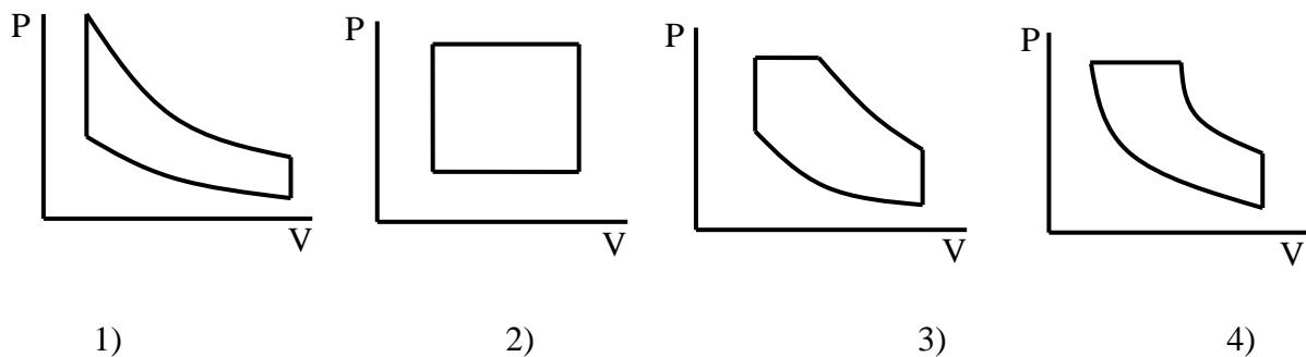
14. При анализе теплового баланса проектируемой системы цикл Ренкина в координатных осях P-V показан на диаграмме:
