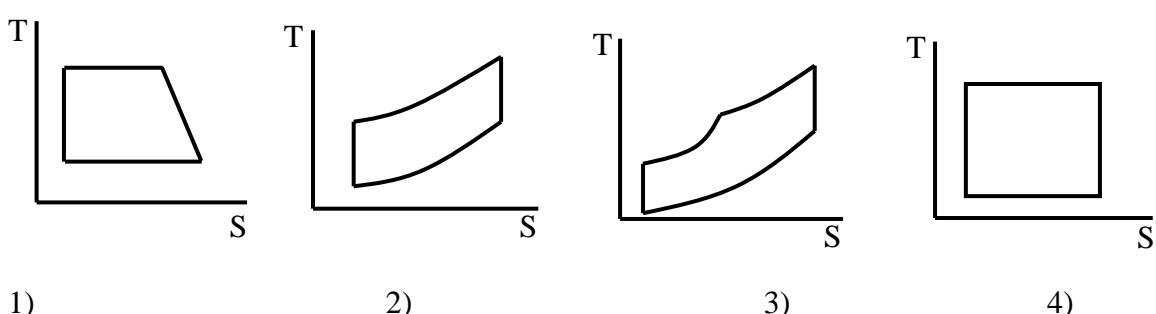
12. При анализе теплового баланса проектируемой системы цикл Дизеля в координатных осях  $T$ - $S$  показан на диаграмме:
